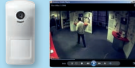
ISN3010B4 Détecteur à infrarouge passif avec capteur d'images intégré
